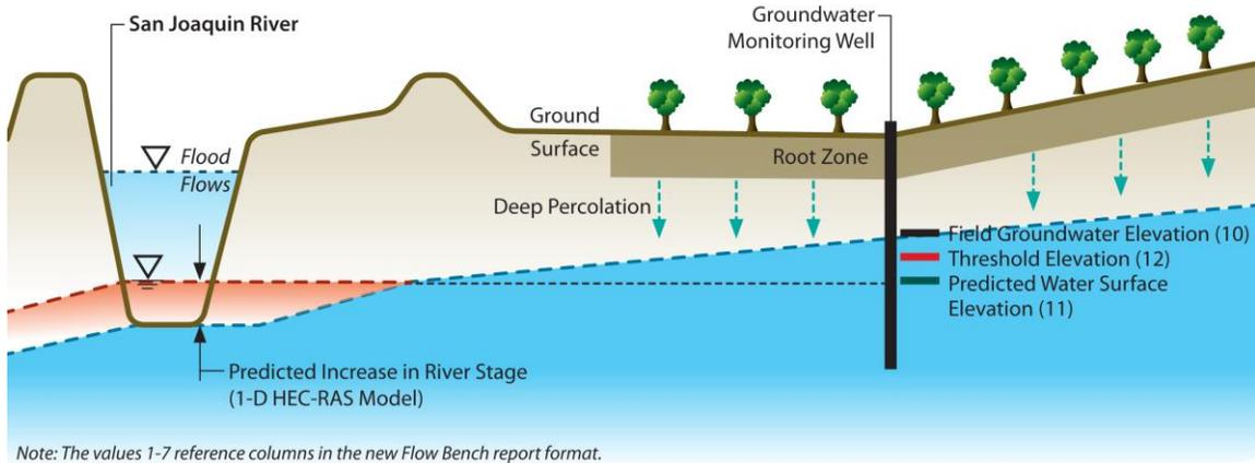
**Figure J-3. Drainage Method**
